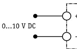
An analoge Eingänge kann eine Spannung von 0 bis 10 V DC angelegt werden. Der typische Eingangsstrom bei 10 V beträgt ca. 100  $\mu$ A.
