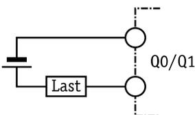
Die digitalen Ausgänge sind potentialfrei und können Gleich- oder Wechselspannungen von max. 125 V schalten. Die Belastbarkeit pro Ausgang liegt bei 0,12 A.
