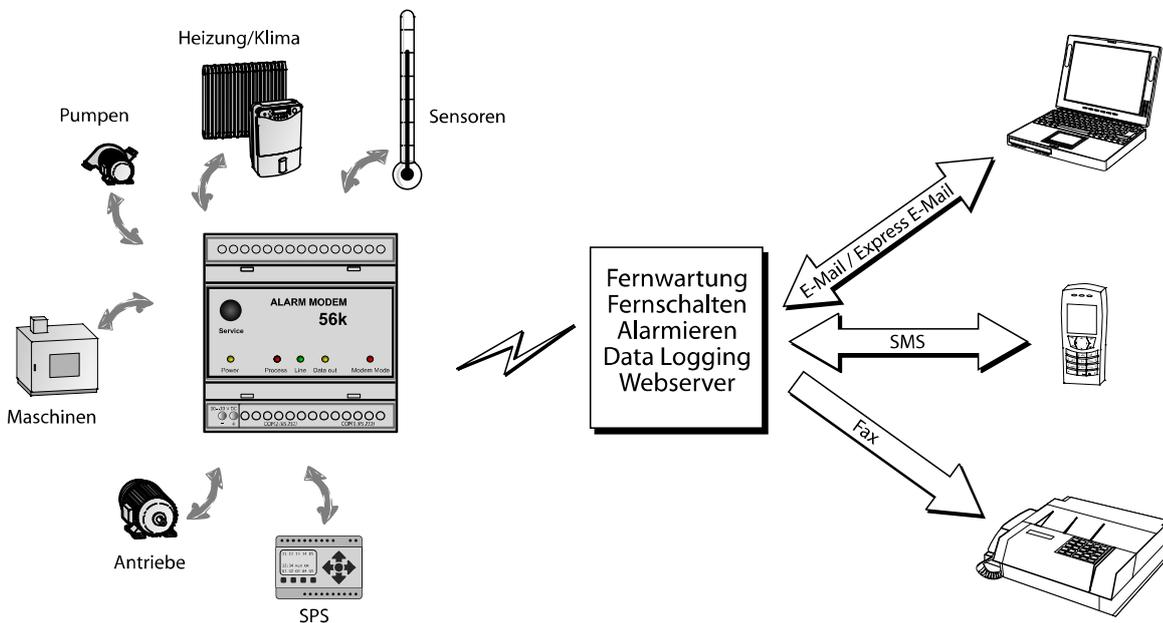
Aufgrund der vielseitigen Funktionalität der Tixi Alarm Modems ergeben sich vielfältige Anwendungsbereiche, wie z.B. die Überwachung von Temperaturen, Drücken, Füllständen oder die Aktivierung von Motoren, Lüftern, Pumpen, Schiebern und Klappen.
