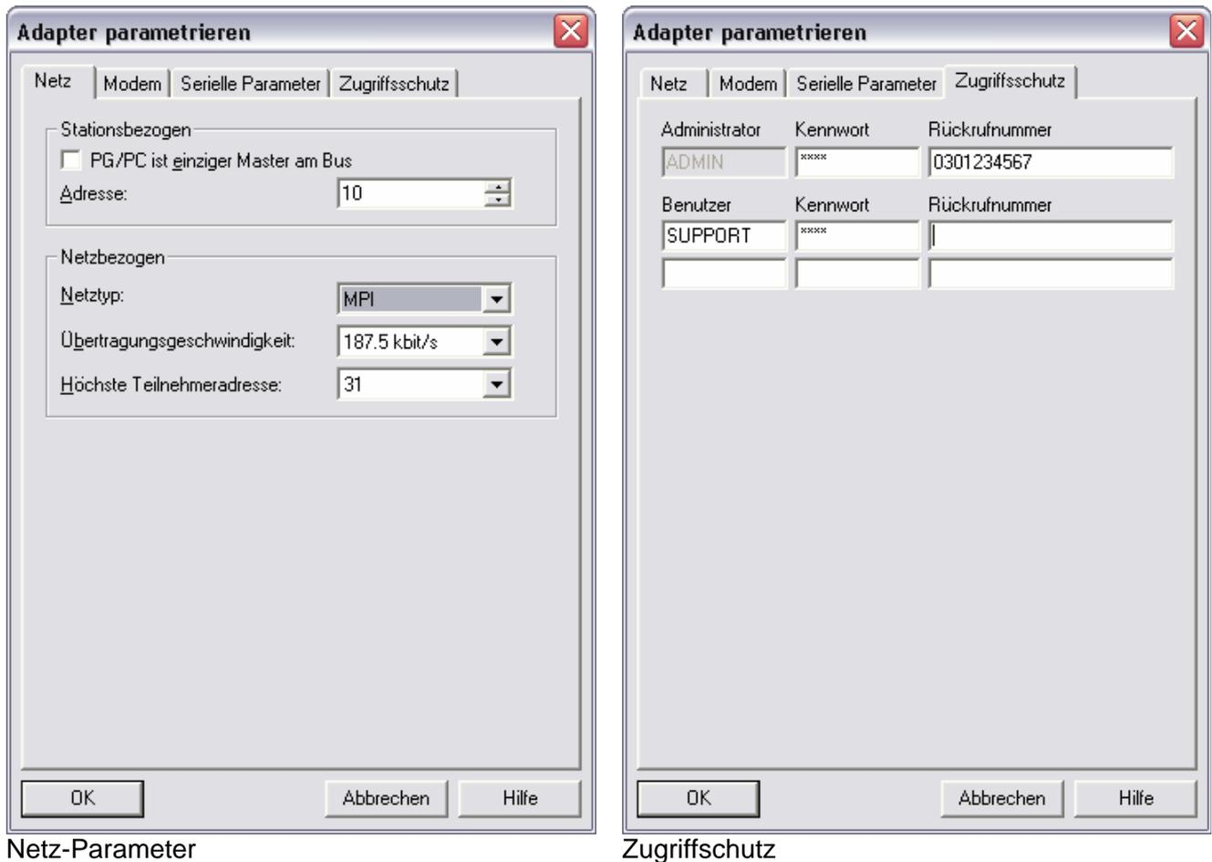
Wenn in das Alarm Modem ein TILA-SPS-Projekt mit S7-300/400-Verbindung geladen wurde, werden die in der TeleService-Software festgelegten Parameter deaktiviert. Es gelten von nun an die in TILA eingegebenen MPI-Einstellungen.
