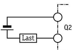
An die Relais-Ausgänge können ohmsche oder induktive Lasten direkt angeschlossen werden. Die Belastbarkeit pro Ausgang liegt bei 3 A / 230 V AC oder bei 0,3 A / 110 V DC.
