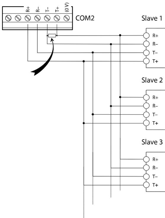
Die Terminierung der Empfangsleitungen wird über die DIP-Schalter aktiviert. Die Sendeleitungen sind extern zu terminieren (siehe Abbildung, Pfeil).
