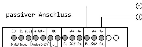
Die nebenstehende Darstellung zeigt die Verdrahtung des S0-Bus exemplarisch am Beispiel des Anschlusses S02. Beim Anschluss an die Schnittstelle S01 ist analog zu verfahren.
