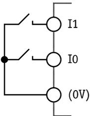
Die digitalen Eingänge können über Schalter oder Relaiskontakte *potentialfrei* beschaltet werden.
