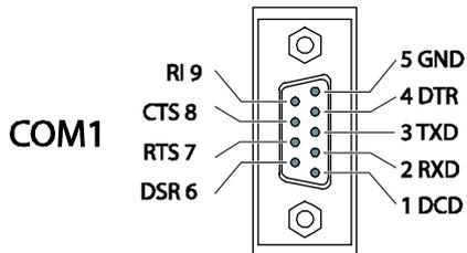
Die RS232-Schnittstelle COM1 (9-polige D-Sub-Buchse) ist bei allen Tixi Alarm Modem Modellen vorhanden. Sie dient in erster Linie als Programmierschnittstelle zum Anschluss eines PCs. Dazu kann ein handelsübliches serielles Kabel 1:1 verwendet werden (nicht im Lieferumfang enthalten).
