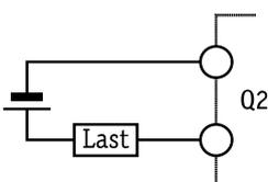
An die Relais-Ausgänge können ohmsche oder induktive Lasten direkt angeschlossen werden. Die Belastbarkeit pro Ausgang liegt bei 3 A / 230 V AC oder bei 0,3 A / 110 V DC.
