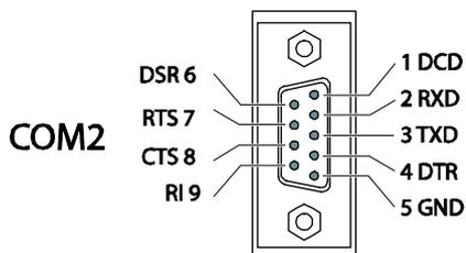
An die mit COM2 bezeichnete 9-polige RS232-Schnittstelle (Stecker) kann eine Steuerung direkt angeschlossen werden, denn die COM2 entspricht der Standard-RS232-Schnittstelle eines PCs.
